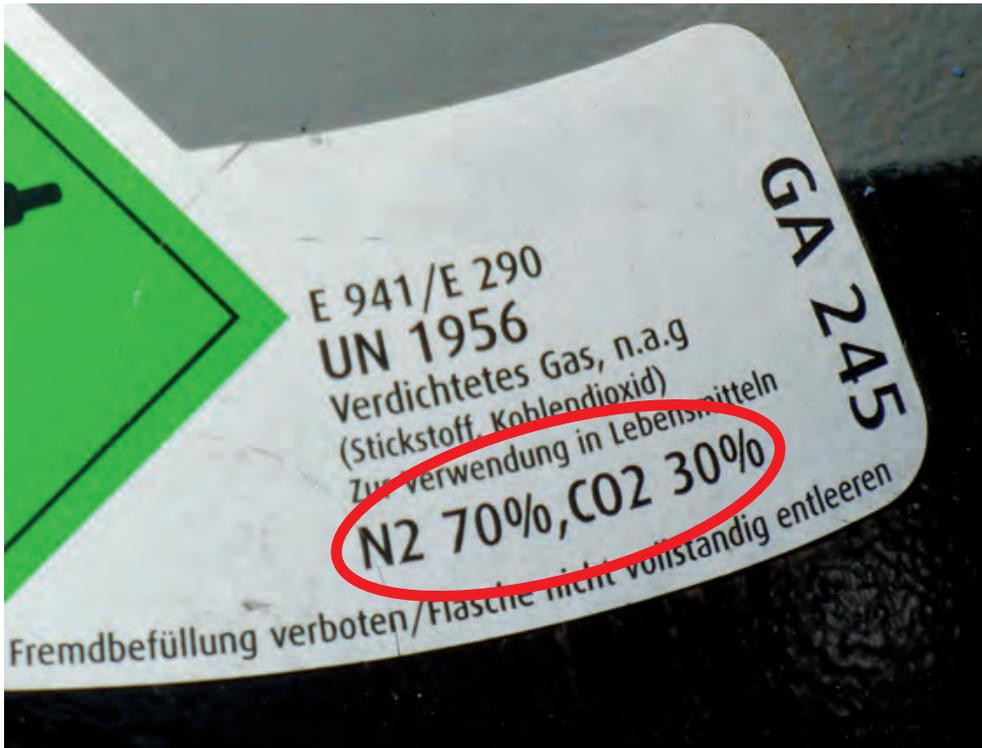
Abb. 2: Beispielhafte Beschriftung einer Druckgasflasche mit Mischgas N<sub>2</sub>: 70 %, CO<sub>2</sub>: 30 %
