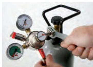
5. Druckminderer mit Werkzeug festziehen
