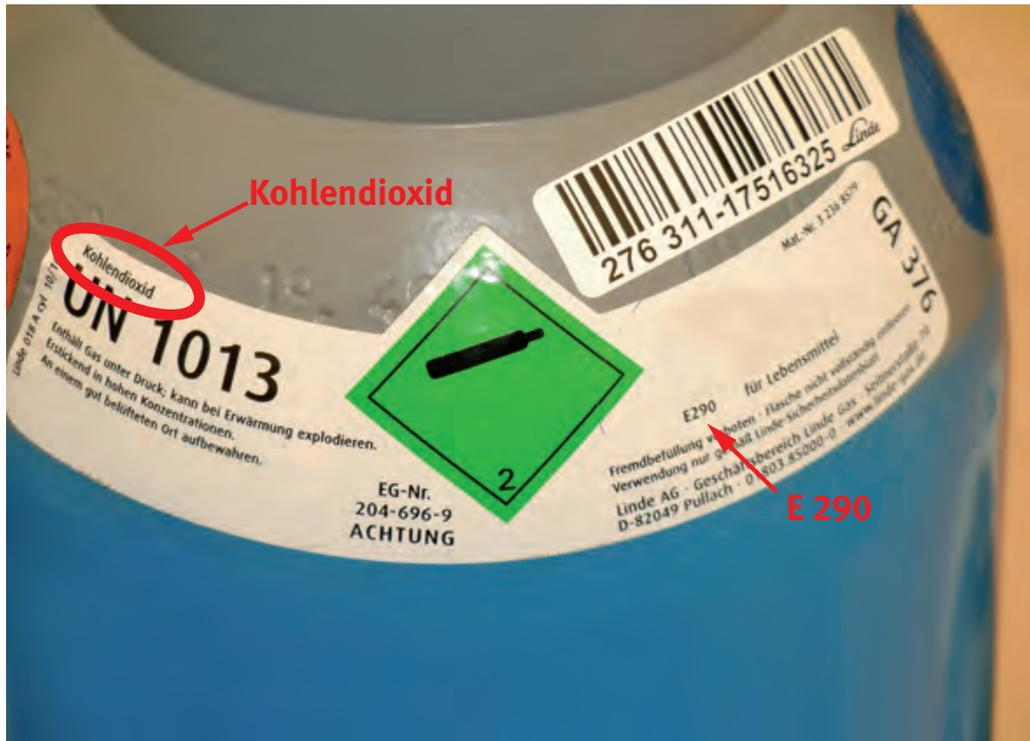
Abb. 1: Beispielhafte Beschriftung einer Druckgasflasche mit dem lebensmittelrechtlich unbedenklichen Schankgas Kohlendioxid (CO<sub>2</sub> - E 290)
