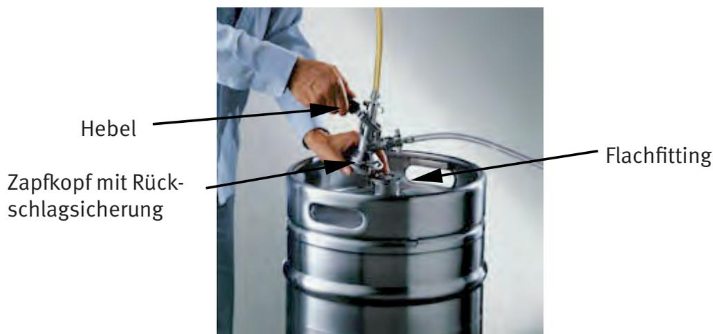
Abb. 14: Keg-Anschluss mit Flachfitting
