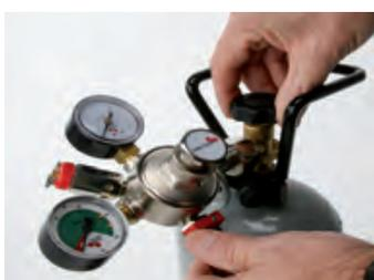
6. Druckgasflasche bis zum Anschlag öffnen sowie Absperrhahn öffnen
