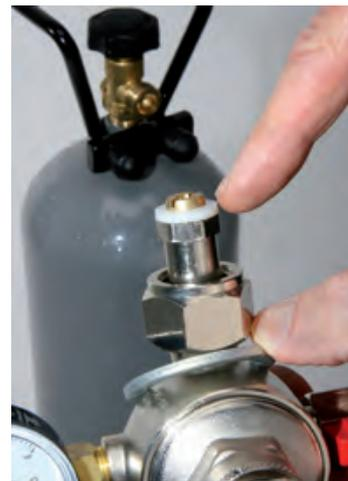
3. Dichtung am Druckminderer kontrollieren
