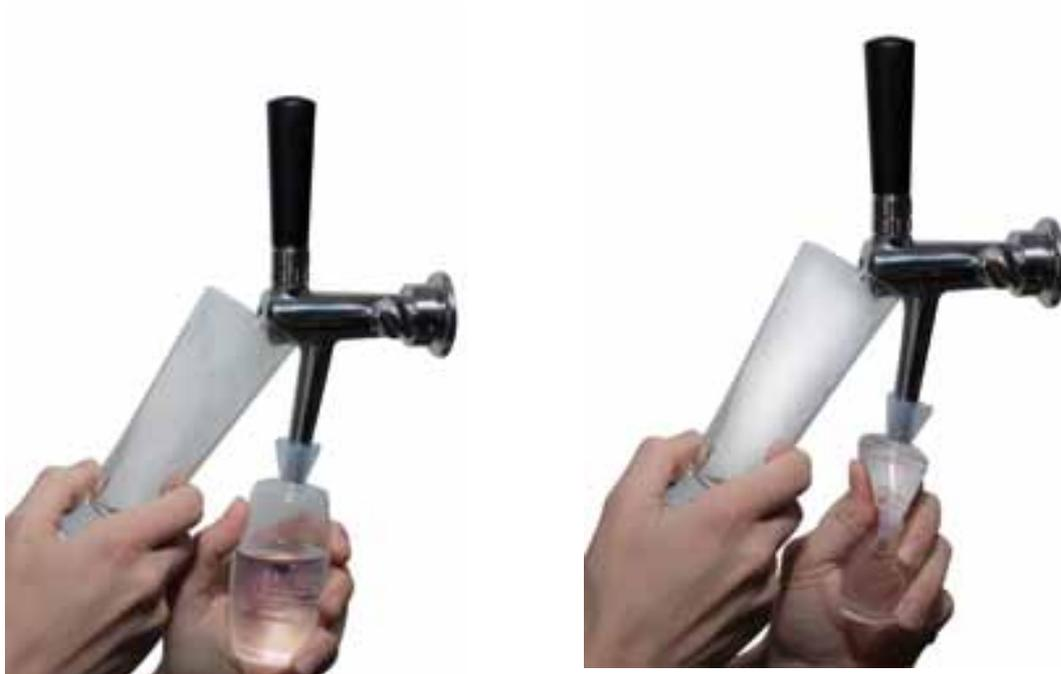
Abb. 2: Spülen des Hahnauslaufes und der Luftbohrung mittels Reinigungsball
