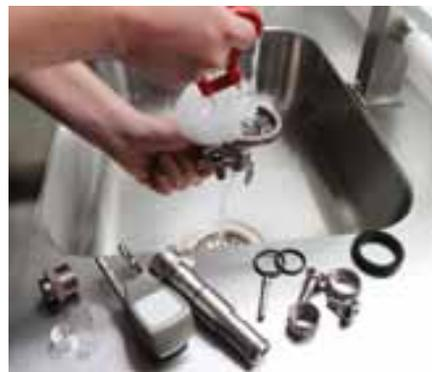
Abb. 6: Zerlegter Zapfkopf zur gründlichen Reinigung
