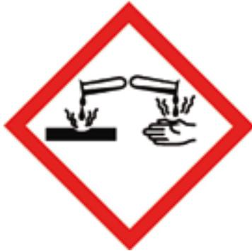
Abb. 13: Kennzeichnung eines Stoffes mit Ätzwirkung
