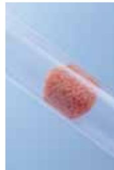
Abb. 12: Gepresste Schwammkugel im Leitungssystem
